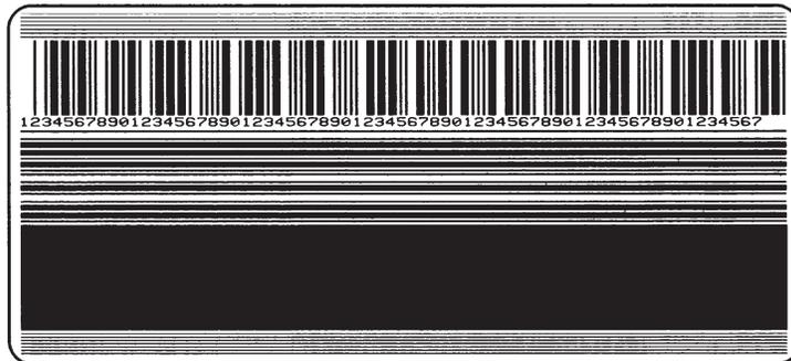
**Figure 3-2. PAUSE Key Test Sample Label**
