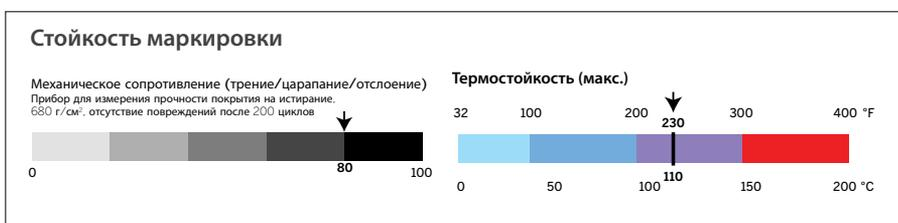
Оценка экспертами Videojet установленной производительности риббона Ультра при оптимизированных настройках принтера и датчиков.
